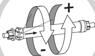
Pour accéder à la barre de force et ajuster le rappel du rideau, ôter les caches latéraux (8 et 9) et décaler le volet roulant vers soi.
