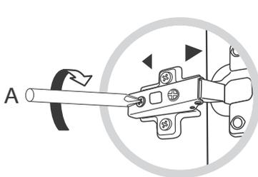
Desserrer/serrer pour ajuster la porte horizontalement
