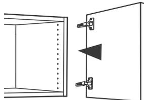
Pour identifier l'emplacement des embases sur le caisson, positionner la porte avec les charnières devant le caisson et repérer les trous concernés
