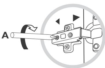
Desserrer/serrer pour ajuster la porte horizontalement
