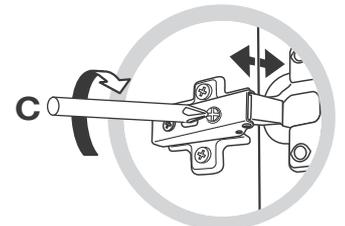
Desserrer, bouger, puis serrer pour ajuster l'écart porte/caisson
