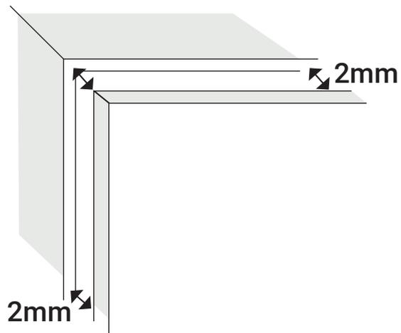
Actionner la vis pour ajuster l'écart entre la porte et le caisson.
