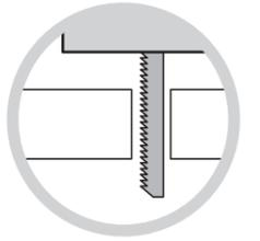
Avec une mèche à bois, percer à chaque angle un trou de taille suffisante pour y passer la lame de la scie sauteuse
