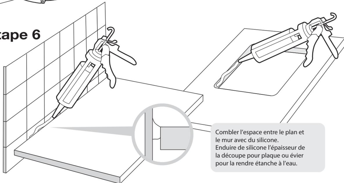
Comblent l'espace entre le plan et le mur avec du silicone. Enduire de silicone l'épaisseur de la découpe pour plaque ou évier pour la rendre étanche à l'eau.
