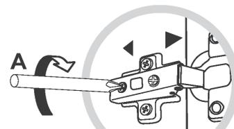
Desserrer/serrer pour ajuster la porte horizontalement
