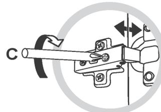
Desserrer, bouger, puis serrer pour ajuster l'écart porte/caisson
