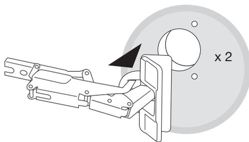
Positionner les charnières sur la nouvelle porte et clipser simplement la cuvette.
