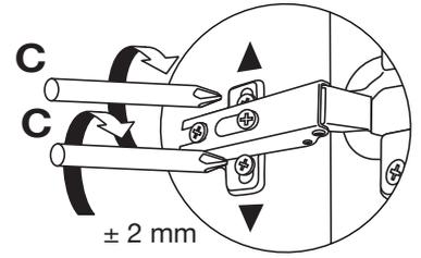
Desserrer légèrement les vis de fixation de l'embase et ajuster la hauteur de la porte. Puis bien resserrer les vis.
