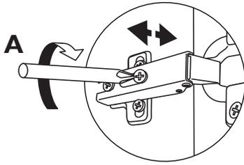
Visser pour diminuer le recouvrement de la porte sur le caisson et dévisser pour l'augmenter.
