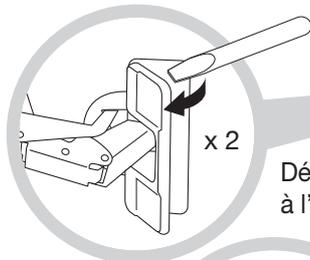
Déclipser la cuvette à l'aide d'un tournevis.
