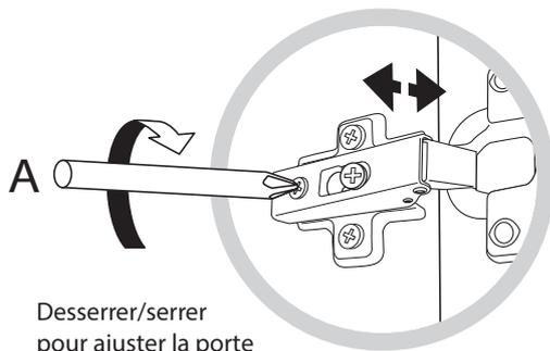
Desserrer/serrer pour ajuster la porte horizontalement
