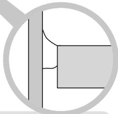
Pour les plans en contact avec un mur, laisser un espace de dilatation de quelques millimètres.
