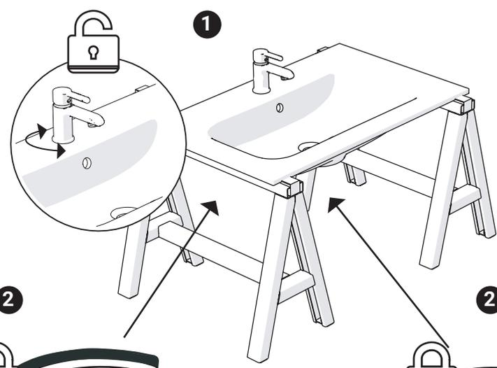
Réglez le positionnement du robinet avant serrage complet
